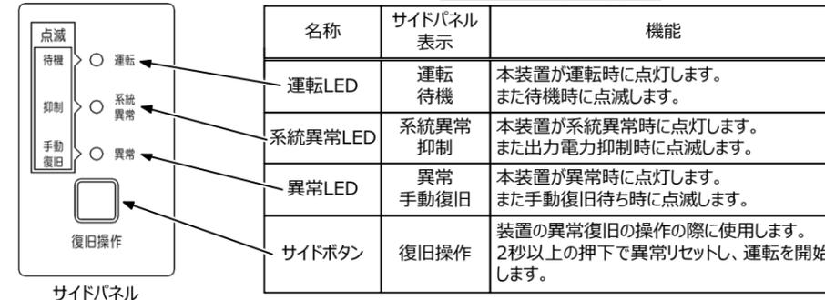
LCDおよびサイドパネルのLED、接点信号の状態表示一覧
