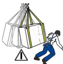
機器の輸送時、特にトラックなどによる陸送による輸送は、激しい衝撃、湿度、振動などによってコンポーネント(特に電子コンポーネント)などが損傷しないよう適切な梱包を行ってください。また、製品運搬の際には、危険な揺れを引き起こさないようにゆっくり動かしてください。
