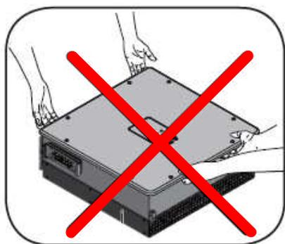
インバータ本体<sup>03</sup>は重量物のため、持ち上げる際は3人以上の作業員で行うか、または適切なつり上げ用器具を使用してください。
