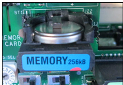
図 8.1 ボタン電池 (DC 接続箱内)
