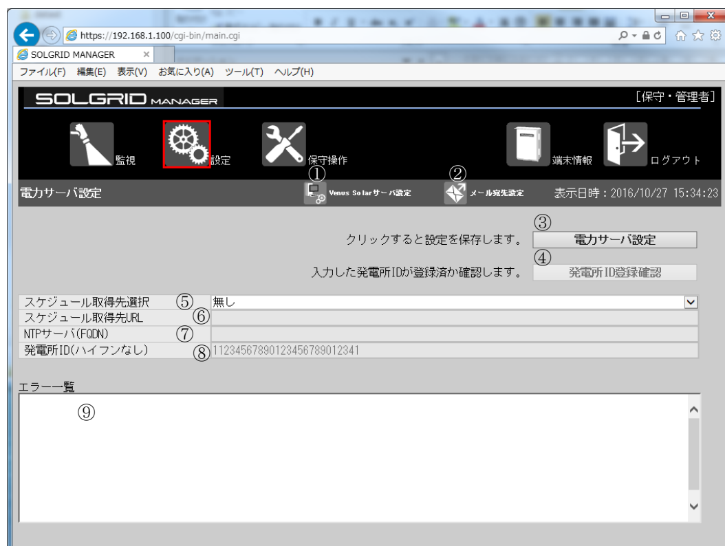
図 3.2-27 電力サーバ設定画面
